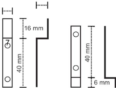
Befestigung der Edelstahlhalter erfolgt mittels Edelstahlschrauben 2,9 x 9,5.
